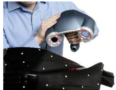
Scanner Creaform avec pastilles de positionnement
