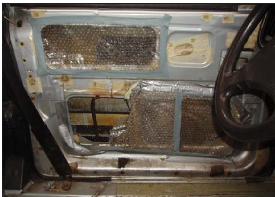
Alla: Jatkettu etuovi sisältä saumat näkyvissä, huomio kuljettajan turvavyön paikka.
