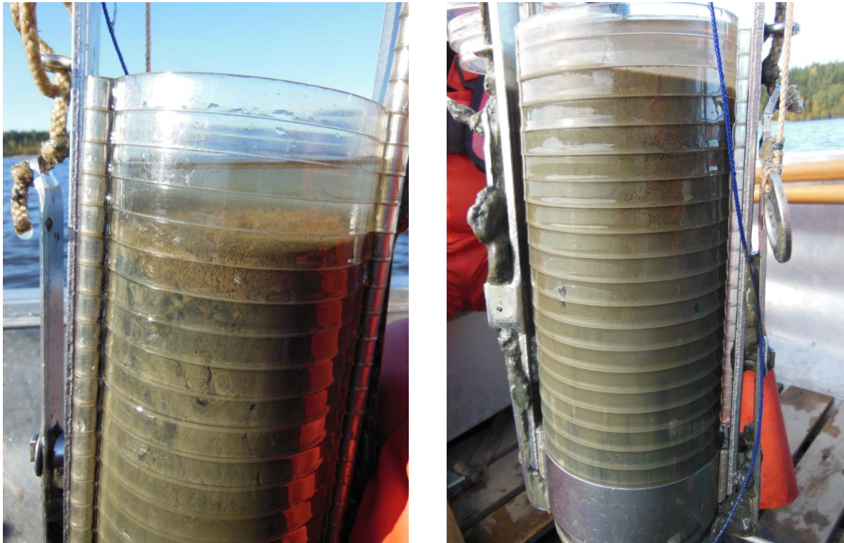
Kuva 15. Sompasen sedimenttinäyte järven syvimmästä pisteestä (So2, 8 m; vasemmalla) sekä matalimmasta pisteestä (So7, 4,2 m; oikealla). Pinnan vaaleaa, vielä hajoamatonta esiliejua lukuun ottamatta syvänteeseen sedimentissä oli runsaasti mustia sulfidiraitoja, etenkin 0-6 cm:n syvyydessä. Matalammalla pisteellä sedimentti oli vaaleampaa, hapekkaissa oloissa kerrostuvaa, mutta myös mustia sulfidiraitoja esiintyi etenkin syvemmällä sedimentissä.
