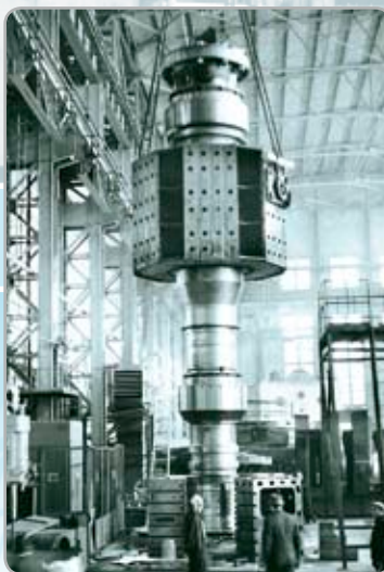
Насадка втулки на вал ротора гидрогенератора Токтогульской ГЭС
