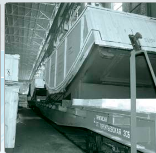
Сектор статора Саратовского гидрогенератора на платформе
