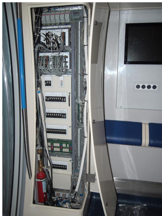
Рис. 31. Шкафы для размещения электро - и пневмооборудования
