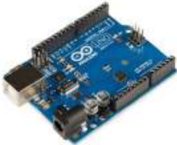
Gambar 2. Arduino UNO R3
