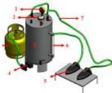
Gambar 1. Desain seperangkat setrika uap
