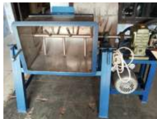
Gambar 2. Mesin Molen ( Mixer ) Adonan Bahan Krupuk
