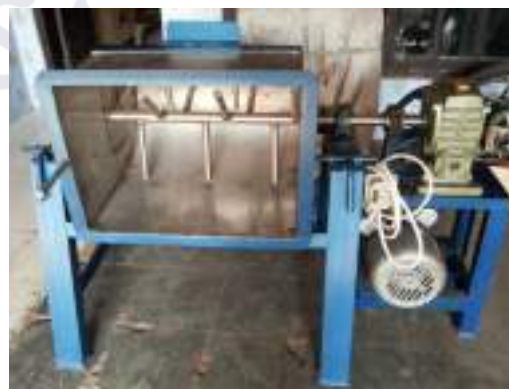
Gambar 2. Mesin Molen (Mixer) Adonan Bahan Krupuk
