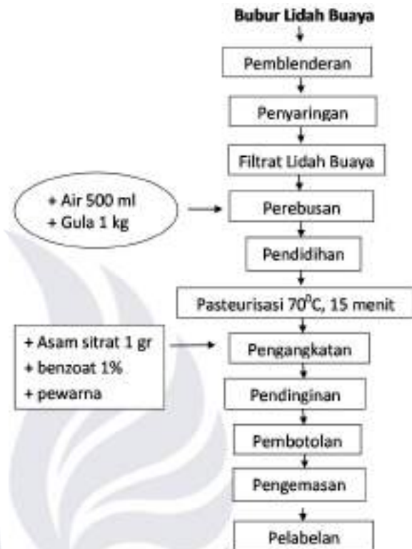
Gambar 1. Tahapan proses pengolahan sirup lidah buaya
