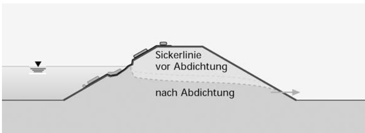
Abb. 56: Abdichten/Sichern von lokalen Wassereintrittsstellen (Schnitt)
