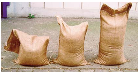
Abb. 69: zu geringe (links), zu volle (rechts) und ideale Sandsackbefüllung (Mitte)
