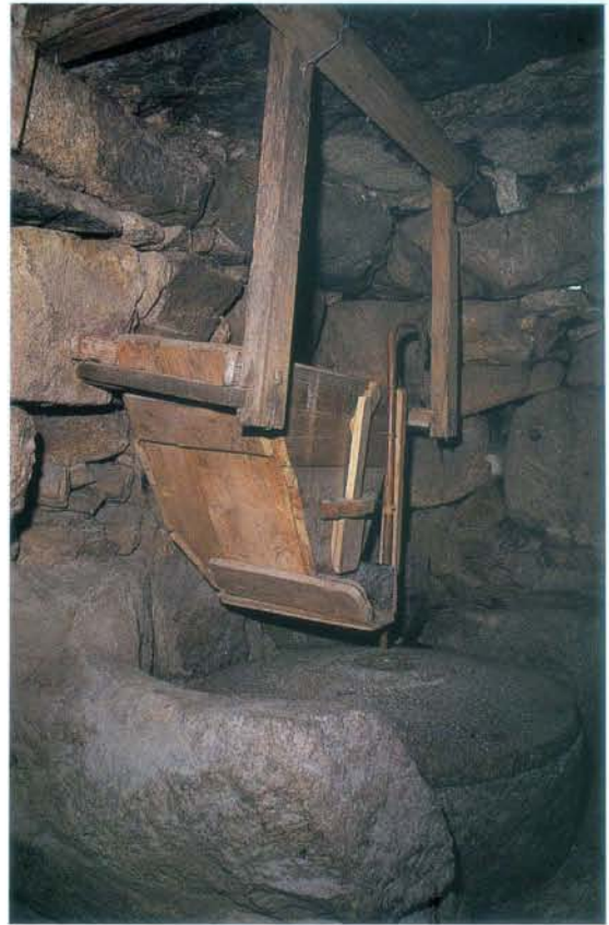
Moinho do Pica. Vista geral do sistema de accionamento com rodízio de penas e seteira e vista da zona de moagem
