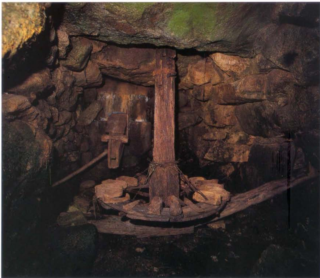
Moinho do Coto da Ponte. Vista geral do sistema de accionamento hidráulico com rodízio de penas e seteira
