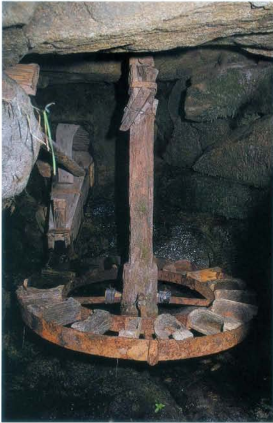
Moinho do Pica. Vista geral do sistema de accionamento com rodízio de penas e seteira e vista da zona de moagem
