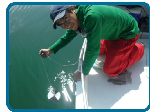
Figura 1. Juan Estuardo Bocel, un estudiante del proyecto utiliza el disco Secchi, instrumento para medir transparencia a través del tiempo.
