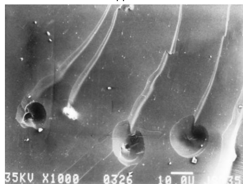
Выброс, трещины; шахта им. Калинина, пласт h_8 , стадия 2Т
