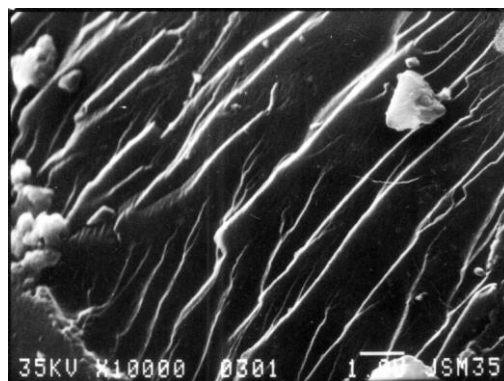
Трещины, шахта Нижняя Крынка, пласт k_8 , стадия 2Т
