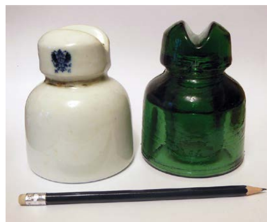
Рис. 1.2: фарфоровый и стеклянный изоляторы российских фабрик
