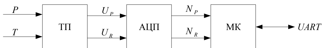
Рис. 5. Структурная схема датчика давления с цифровым выходом
