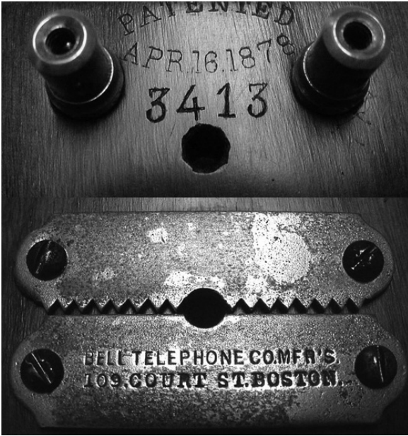
Figura 3. Una de las estaciones del coleccionista Tom Adams y sus dos elementos de identificación. De estos el de la derecha está grabado en la madera de la caja y el de la izquierda en una de las dos plaquitas metálicas del descargador de la línea, que conectadas a los conductores de esta facilitan que pueda saltar la chispa, caso de crearse un alto potencial entre ellos por inducción estática atmosférica u otras causas.
