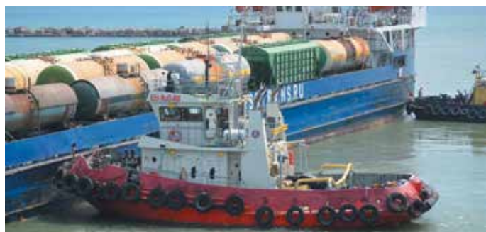
Буксир-кантовщик мощностью 884 кВт проекта TG03 помогает парому проекта 002CNF01
