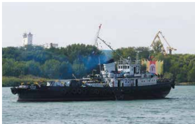
Речной ледокол мощностью 1324 кВт проекта 16 типа «Дон»
