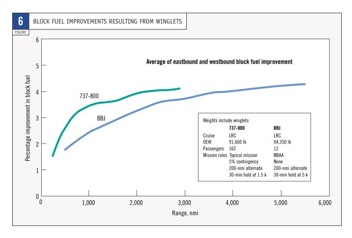
1 PROTOTYPE WINGLET AERODYNAMIC FLIGHT TEST RESULTS
