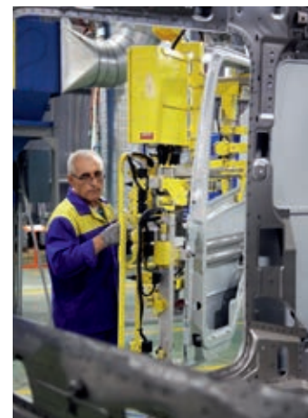
У манипулятора для установки дверей хитрый замок – пока узел не будет закреплён, освободиться от приспособления не получится
