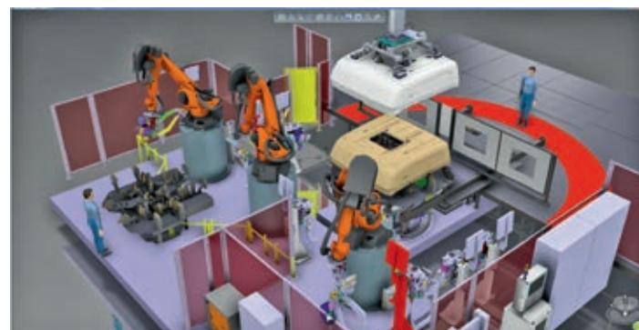
3D-модель роботизированной ячейки сварки крыши кабины
