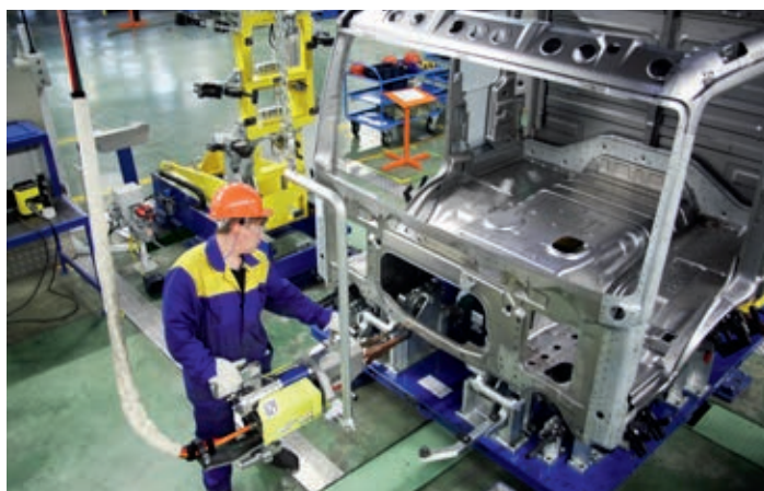
Процесс сборки каркаса начинается с обваривания нижнего пояса кабины
