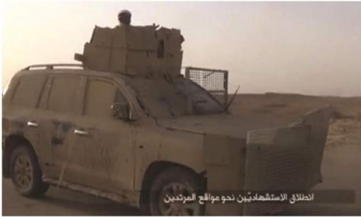
سيارة رباعية الدفع تم تدريبها واطيف لها برج كما في الصورة المقابلة لعربة الهامفي.
