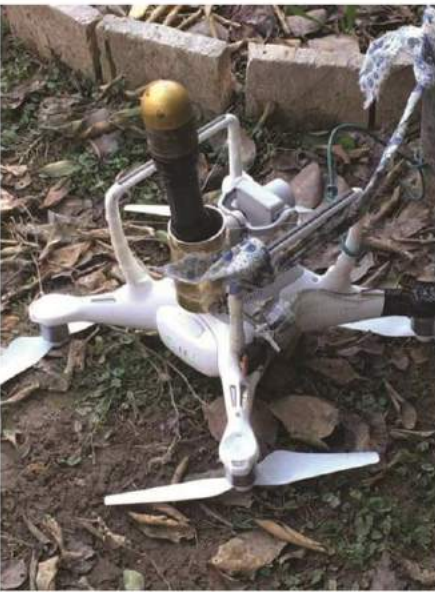
طائرتين من نوعين مختلفين وطريقة حمل كل واحدة للقذيفة ومدى التعديلات التي اضيفت على قذائف عيار 40 ملم
