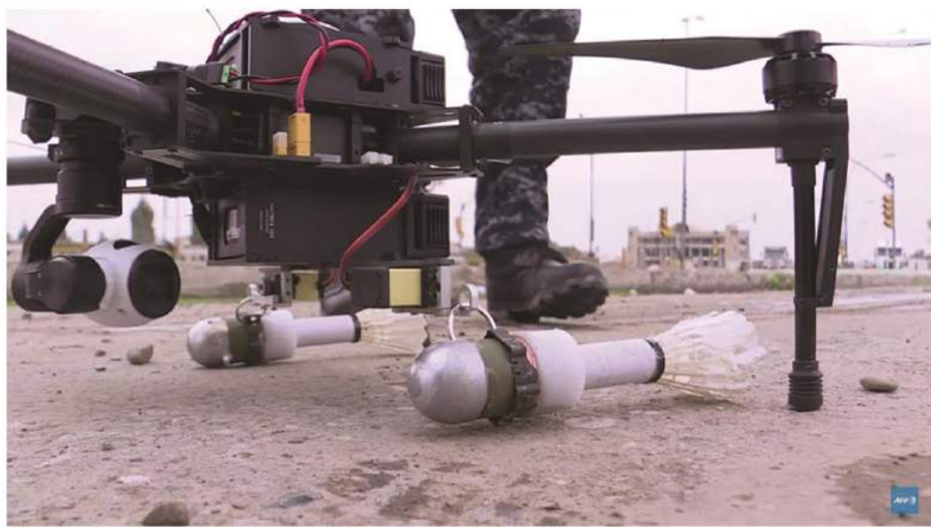
طائرتين من نوعين مختلفين وطريقة حمل كل واحدة للقذيفة ومدى التعديلات التي اضيفت على قذائف عيار 40 ملم
