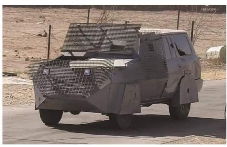
سيارة رباعية الدفع تم تدريع الجزء الأمامي منها بألواح الفولاذ ودروع قفصية على المحرك والمقدمة.
