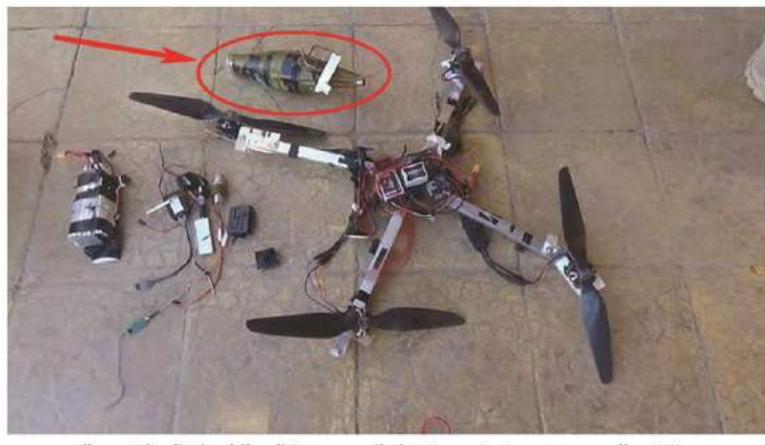
طائرة بدون طيار كانت مجهزة بقذيفة خاصة بالقاذف الكتفي RPG-7.
