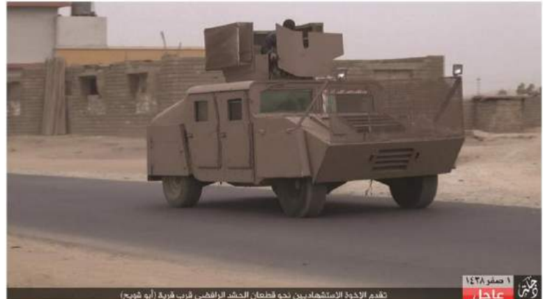
عربة هامفي أضيف لها دروع في المقدمة وعلى العجلات ودرع قفصي لحاية النافذة الامامية. وتدريب اضافي للبرج المسلح برشاش ثقيل والذي يوفر تغطية نارية لتقدم الهامفي المفخخة نحو الهدف المطلوب.
