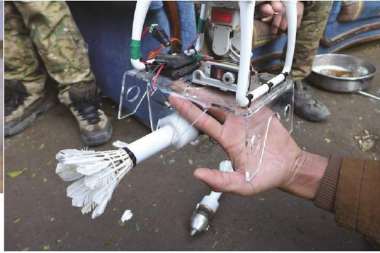
توضيح لألية حمل القذيفة وطريقة القائها.
