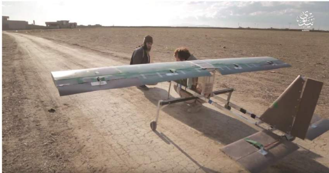
طائرة انتحارية محلية الصنع تحمل شحنة ناسفة وكاميرا مراقبة ويتم توجيهها عن بعد حتى الهدف المطلوب وعند وصولها يتم تفجيرها فوق الهدف .
