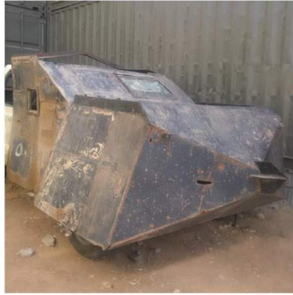
سيارة مدنية جرى تدريعها . ويلاحظ التصميم المتقن للدروع بحيث تكون مائلة قدر الامكان.
