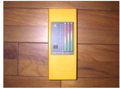
照片 3- 47 牆體磚石材測濕計
