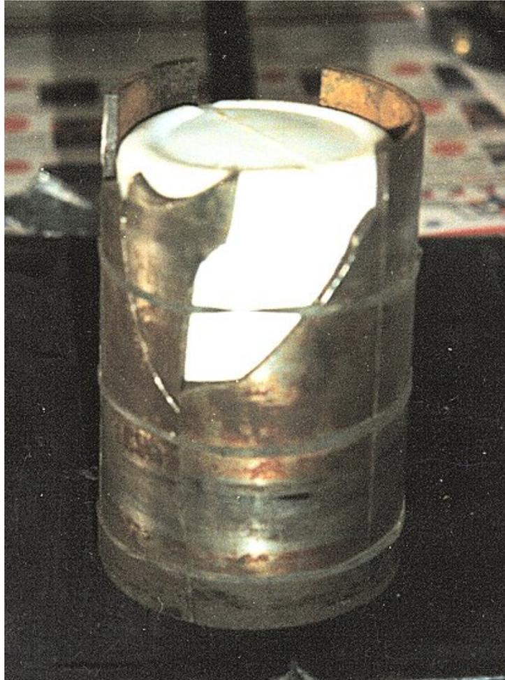
**Рис. 17. Фотография расколовшегося верхнего цилиндрического вкладыша, обломки которого стали причиной заклинивания ангела в 2002 году**
