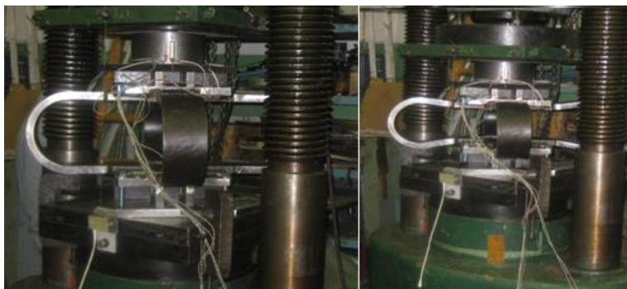
Рис. 3. Установка ПД на пресс в исходное положение, и после сжатия
