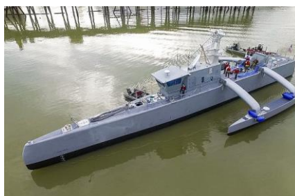
Рис.4. Военно-морской противолодочный беспилотник из композитных материалов
