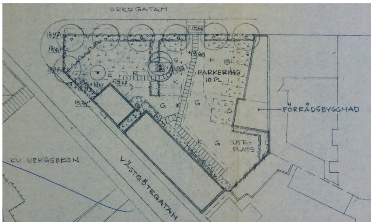
Gestaltningförslag av fastigheterna Mjölaren 14 och 15 från 1968. Verkstads- och bodbyggnaden, här kallad "Förrådsbyggnad" är här befintlig. I förslaget skulle stora ytor beläggas med kullersten och en brunn bevaras på området för att återskapa känslan av stadsgården. Trädplanteringen på toften har i stora drag efterföljts. Foto från Norrköpings stadsarkiv.
