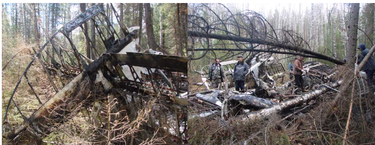
Рис.2. Вид планера самолёта после пожара
