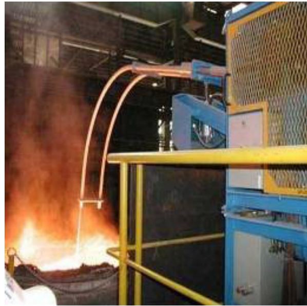
Рисунок 2.19 – Станція та установка для модифікування розплаву порошковим дротом при виробництві ЧВГ
