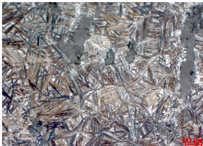
Рисунок 3.18 – Мікроструктура ЧВГ після ізотермічного гартування при 310°C протягом 60 хв.
