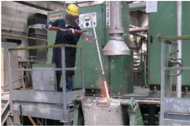
Рисунок 2.6 - Вимірювання активності кисню в тиглі індукційної печі та у розливальному ковші [43].
