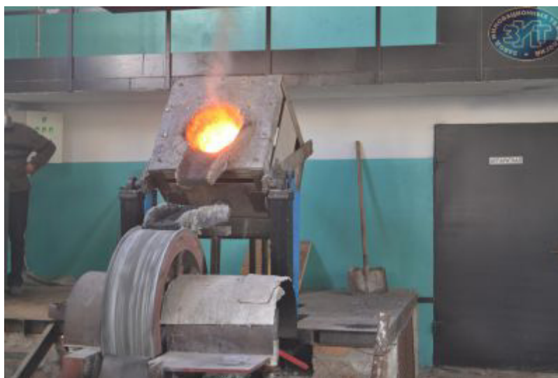
Рисунок 2.28 – Підготовка до розливки «чіпс»- модифікаторів
