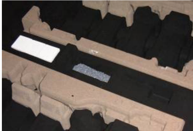
Рисунок 2.23 – Частина ливарної форми з реакційною камерою заповненою модифікатором та встановленим фільтром
