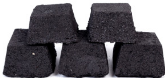
Рисунок 2.30 – Пресовані брикети для графітизуючого модифікування розплаву всередині ливарної форми.
