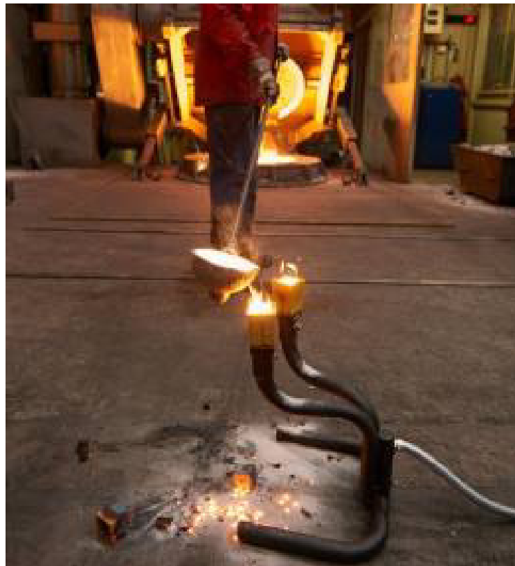
Рисунок 2.11 – Заливання проб при проведенні термічного аналізу чавуну з вермикулярним графітом
