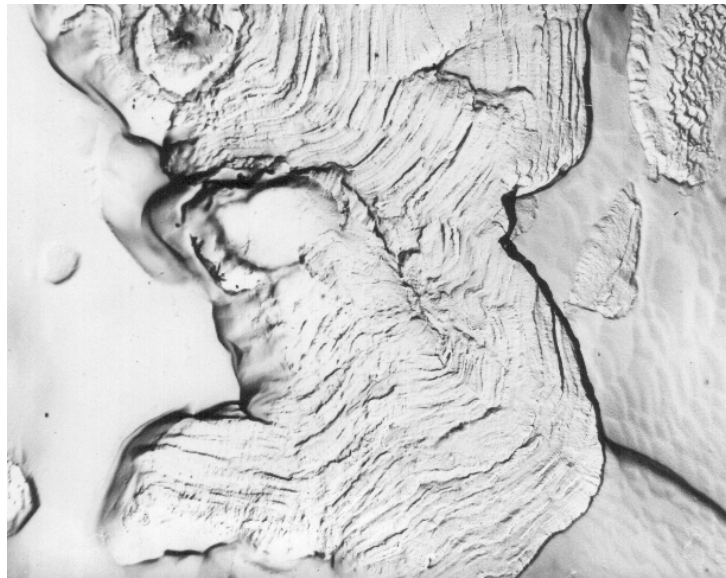
Рисунок 1.6 – Будова включення вермикулярного графіту, х 2000
