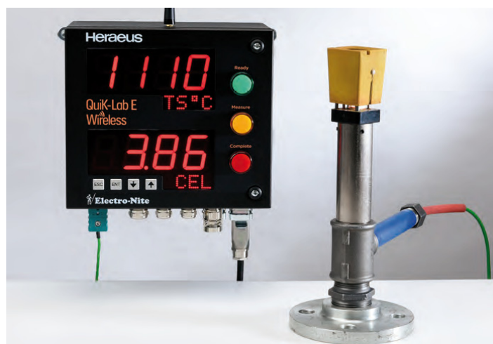
Рисунок 2.10 - Прилад для проведення термічного аналізу QuiK-Lab® фірми Heraeus Electro-Nite.
