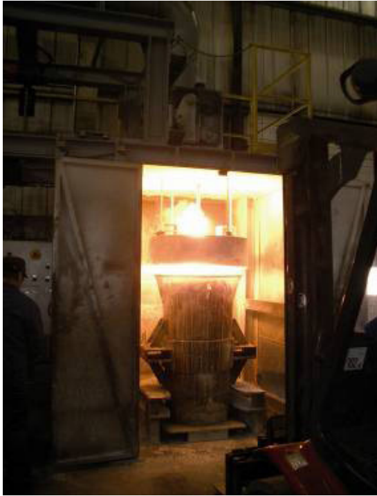
Рисунок 2.19 – Станція та установка для модифікування розплаву порошковим дротом при виробництві ЧВГ
