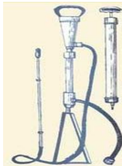
Рис. 34. Гідралічні обприскувачі з ручним приводом (ліворуч – позиційний гідропулт, праворуч – ручний)
