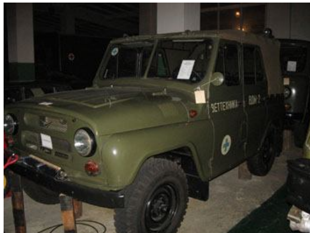
Рис. 36. Ветеринарно-дезінфекційна машина (ВДМ-2) на шасі УАЗ-469
