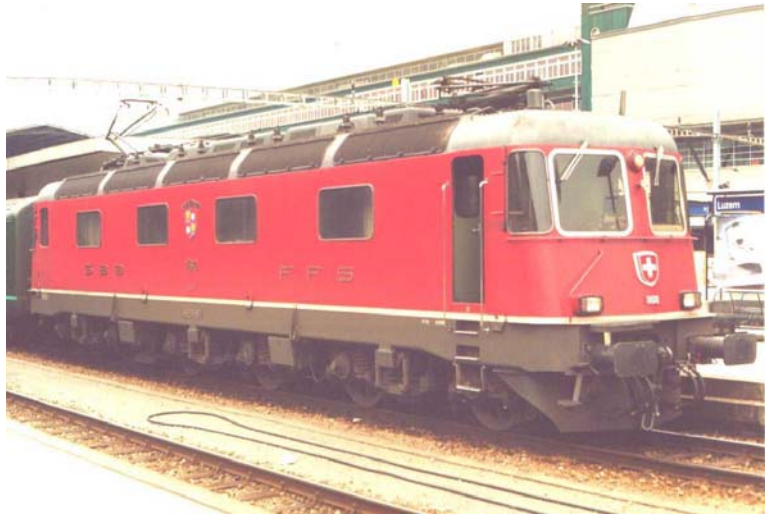
Figuur 94: Zesassige locomotief met drie twee-assige draaistellen (Re 6/6)
