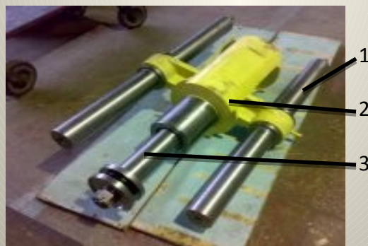
Подвижные детали: 1 – ферромагнитный якорь; 2 – коромысло; 3 – боек
