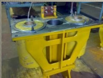
Кассета с параллельно размещенными электромагнитными приводами прямого хода
