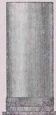
FIG. 43. — Douille en carton à culot de bois.
