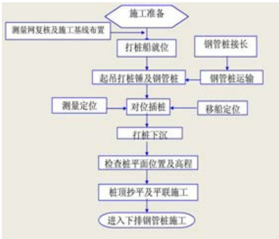
栈桥结构形式及施工工艺流程
