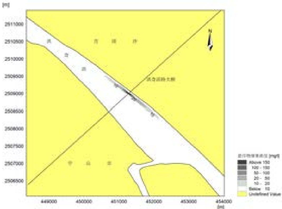
图 4.5.2-2a 洪奇沥特大桥主桥桩基施工（1#）的悬浮物增量浓度包络线
