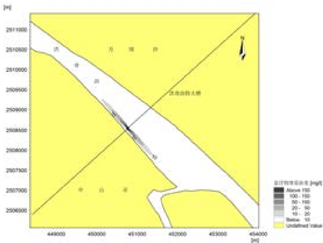
图 4.5.2-2d 洪奇沥特大桥主桥桩基施工（4#）的悬浮物增量浓度包络线
