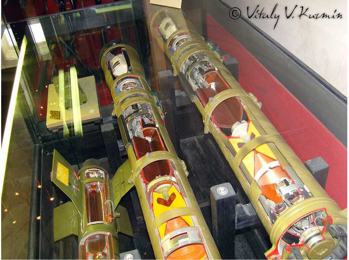
هذه الصورة تبيّن مكونات الصاروخ من الداخل وهو الموجود في الوسط أما على يمين الصورة فهو الصاروخ (أ/ت-4) و أما على يسار الصورة فهو الصاروخ (أ/ت-3)
