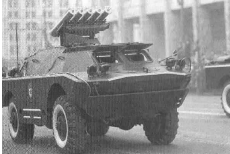
هذه صورة للمركبة المدرعة (ب/ر/د/م-2) وقد ثبت عليها برج يحتوي على 5 صواريخ من نوع (أ/ت-5) بجميع مستلزماتها داخل المدرعة وهي نسخة خاصة بالجيش البولوني فقط.
