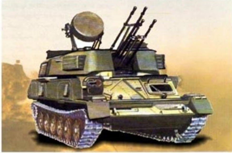
النظام المدفعي المضاد للطائرات عيار ٢٣ مم ZSU-23/4
