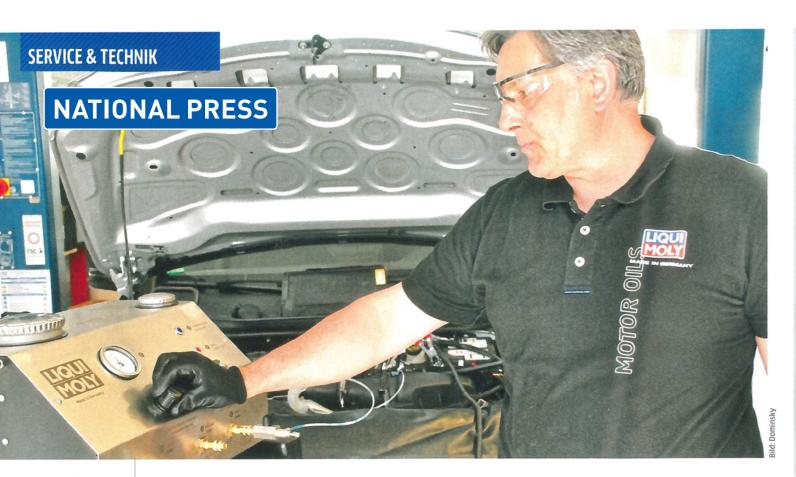
Mit dem neuen Jetclean Tronic II können Werkstätten Motoren von Verunreinigungen und Ablagerungen befreien bzw. diese davor dauerhaft schützen. Aktiv vermarktet können sie mit dieser Serviceleistung zusätzliche Umsätze erwirt-
