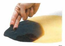
■ Die Öldruck-Kontrolllampe muss beim Einschalten der Zündung aufleuchtet ... 🛮 ... und muss bei laufenden Motor erlöschen. 🗉 Der richtige Ölstand kann über einen Peilstab ... ... oder am Schauglas kontrolliert werden. I Im Gebrauch ändert sich die goldene Farbe des neuen Öls schnell in dunkelbraun bis schwarz, ein Beweis für seine gute Arbeit.
