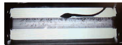
沸騰・二相流の透明伝熱管内の様子
