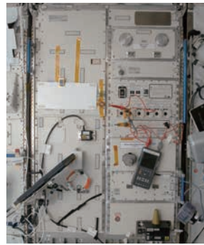
勾配炉ラック
