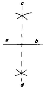
Рис.4. Схема построения перпендикуляра а-в — точки, из которых сделаны засечки; с-д — перпендикуляр.
