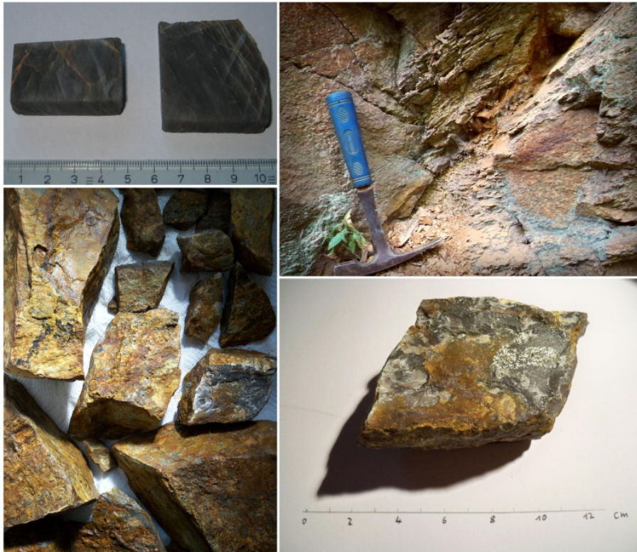
Abb. 5: Gangquarz von Geringswalde mit bis zu 4,3 ppm Gold, welches vermutlich an fein verteilten Pyrit gebunden ist
