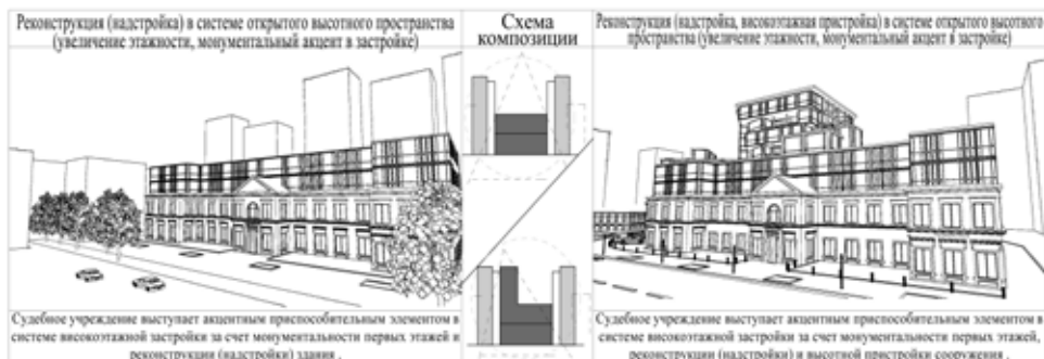
Рис.2. Реконструкция здания суда (пристройка, надстройка).
