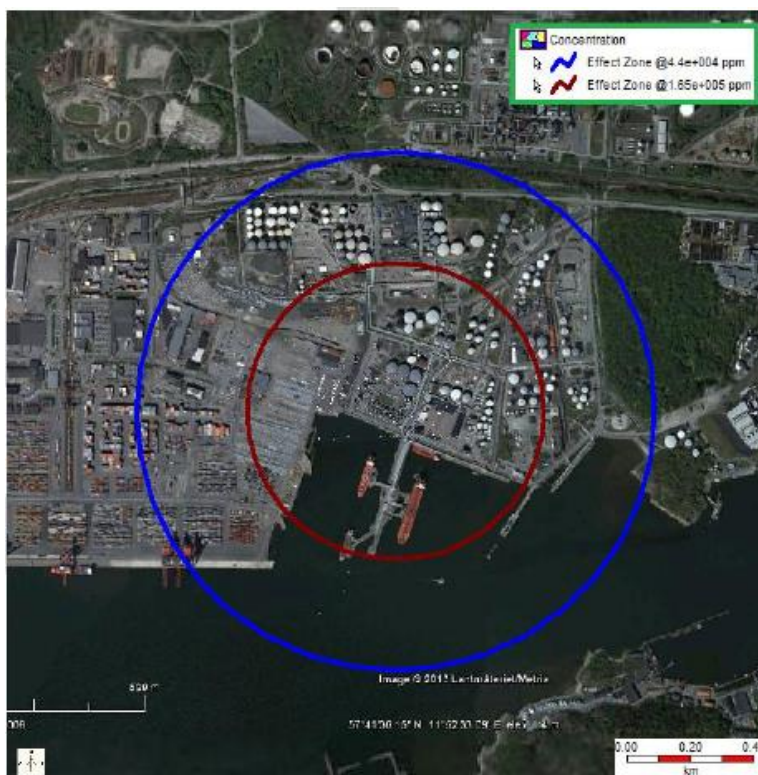
Figur 11:5 Brännbarhetsområde (mellan röd och blå cirkel) för LNG vid kollaps av en bullet-ank för värsta väderscenario, stabilitetsklass F och 1,5 m/s. Figuren visar alla områden som kan drabbas, för ett enskilt tillfälle sker spridning bara i vindriktningen.
