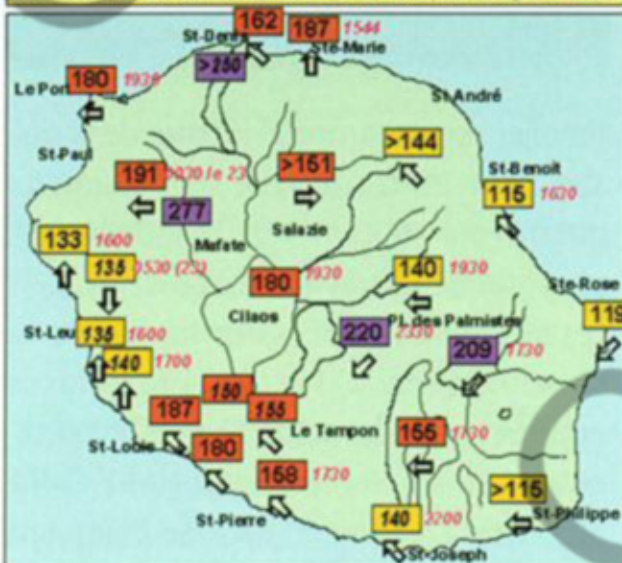
Rafales maximales en km/h entre le 22 et le 23 janvier 2002. Heures à droite de la valeur. Les valeurs en italique ont été estimées d'après des mesures de vent à 2 mètres (stations CIRAD) ou d'après les dégâts constatés.
