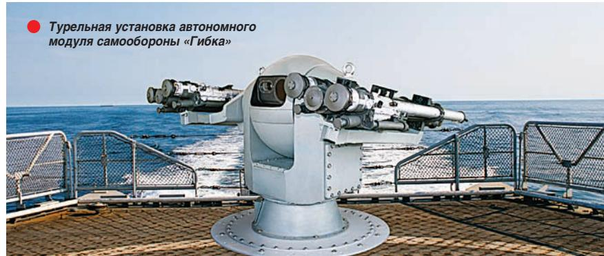
● Турельная установка автономного модуля самообороны «Гибка»
