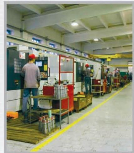
Механическое производство предприятия оснащено современным металлообрабатывающим оборудованием с ЧПУ от ведущих мировых производителей: Mori Seiki (Япония), Sigma (Италия). Конструкторско-технологическая проработка ведется в системах: SolidWorks, SWR-Tech, SWR-PDM. Разработка управляющих программ для обработки деталей на станках с ЧПУ в системах: Sprut-CAM, MORI-APL.
