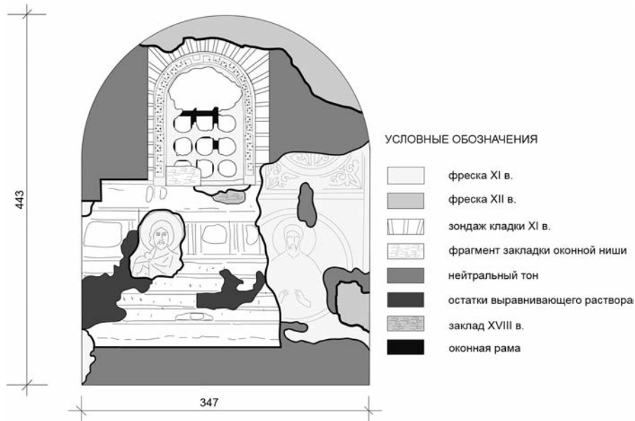
Рис. 4. Северная стена вимы придела свв. Антония и Феодосия. Картограмма после проведения реставрационных работ 2010–2011 гг.
