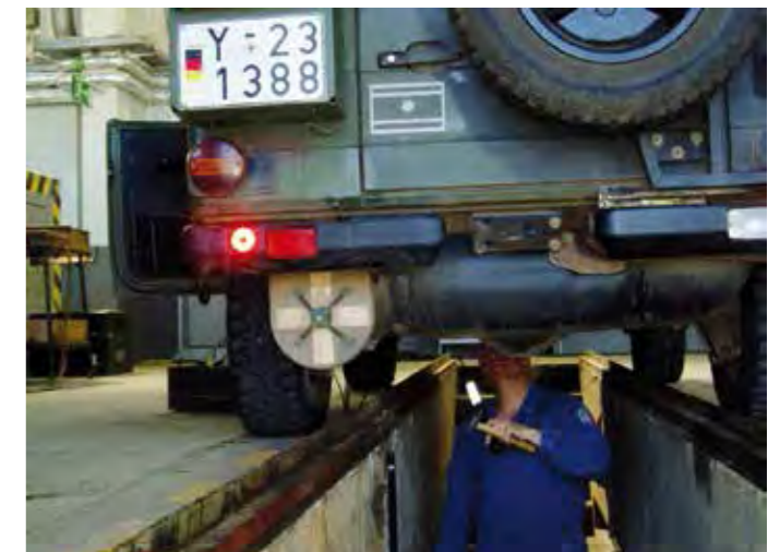
amtlich anerkannter Prüfer bzw. amtlich anerkannte Prüferin mit Teilbefugnissen (aaPmT) der FT Rad/Kette bei der Durchführung der TMP am Fahrzeug DB 250 GD „WOLF“
