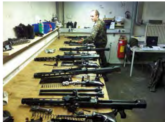
Geräteprüfer SK (FT Waffe) beim Durchführen der TMP an MG 3
