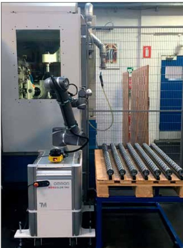
*Fischer Gears invirtió en dos cobots TM de OMRON para automatizar la alimentación de piezas metálicas en cuatro máquinas de CNC.*
