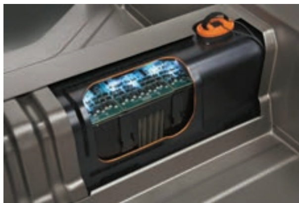
Обязательным является применение BMS (система управления батареями), постоянно следящей за состоянием каждого элемента АКБ
