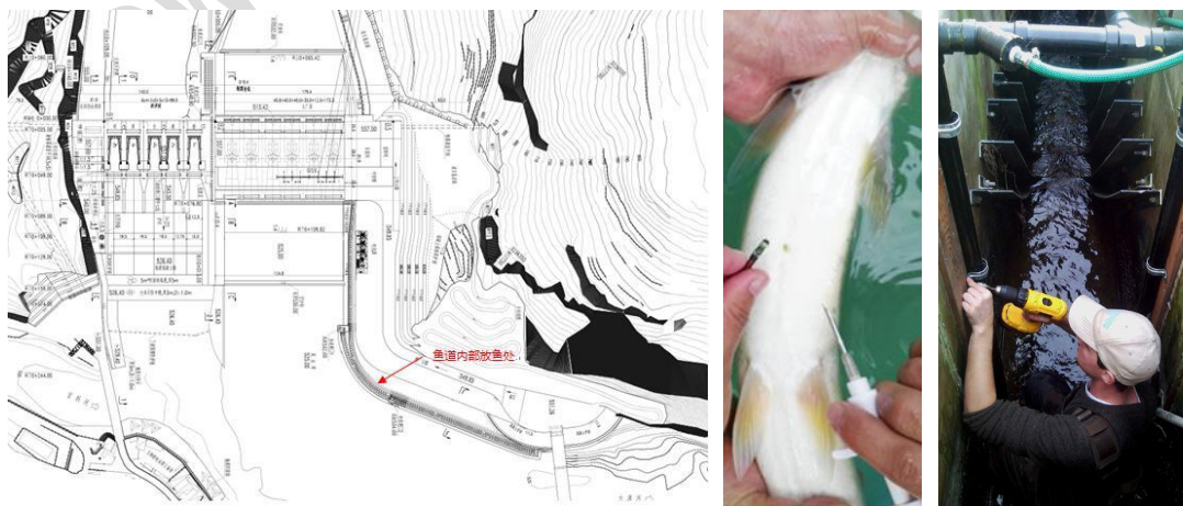
图 2.1-12 鱼道内部 PIT 试验放流点位及现场试验情况
