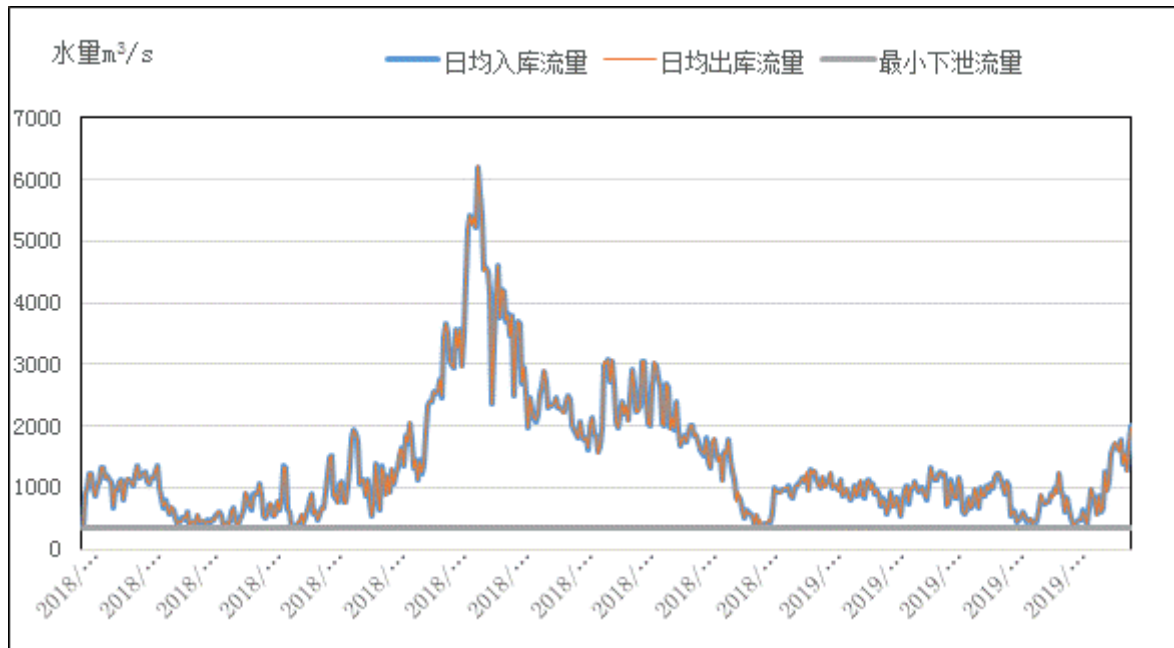
图 3.4-4 沙坪二级水电站水库 2018 年 1 月~2019 年 5 月日均出入库流量变化曲线
