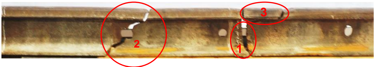
Gambar 20. Potongan patahan rel Km 262+151 petak jalan antara Sta. Lubuk rukam – Sta. Peninjawan
