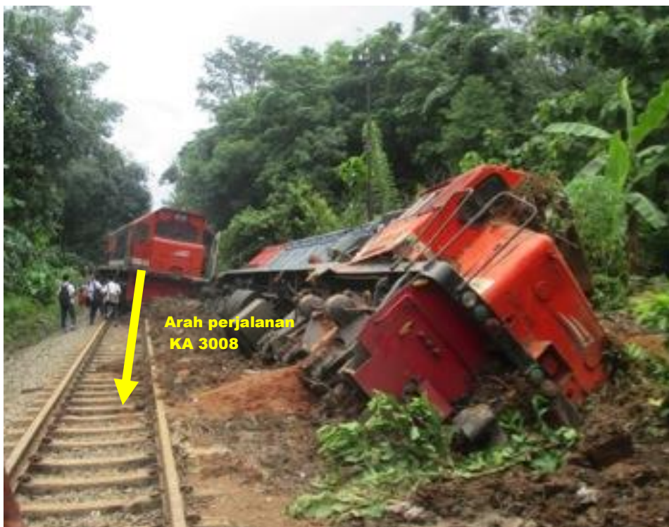
Gambar 2. Lokomotif KA 3008 yang anjlok dan terguling
