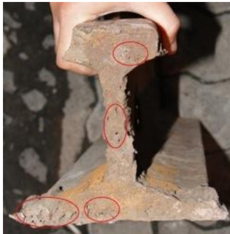
Gambar 6. Porositas pada sambungan pengelasan
