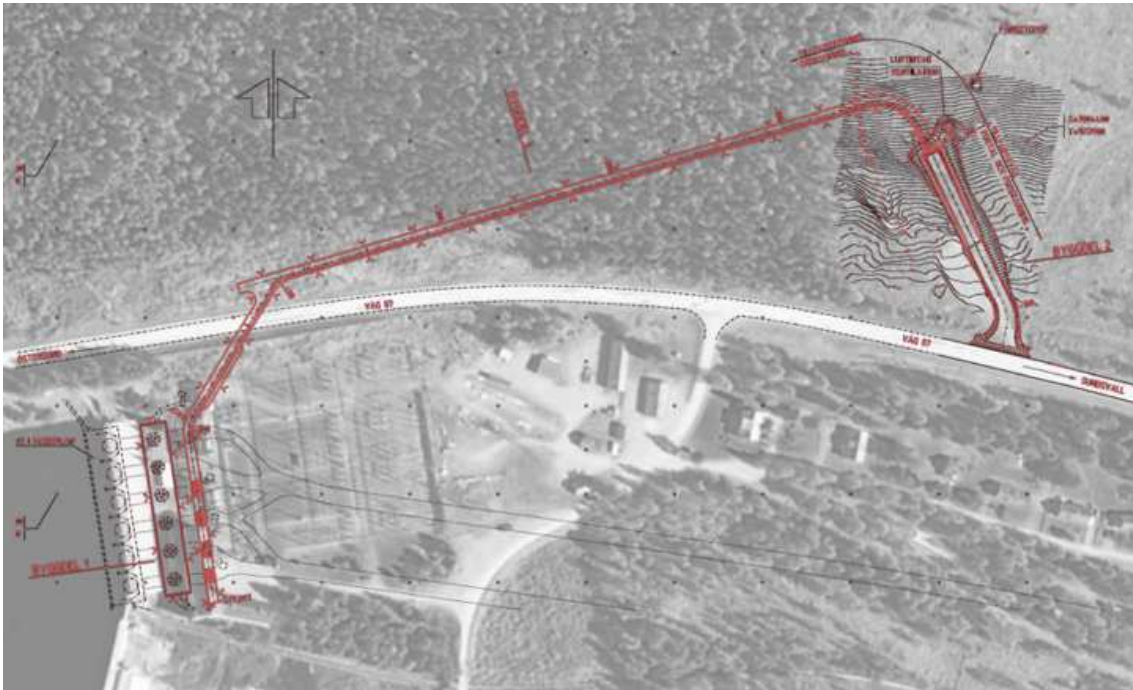
Figur 6. Översikt av ny tillfartstunnel, sugrörsgalleri och sugrörsschakt.
