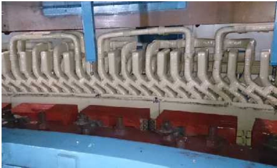
Fig. 2.2.1.3 Devanado del estator.
