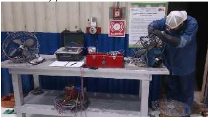
Fig. 4.3.2.1 Limpieza a ventiladores
