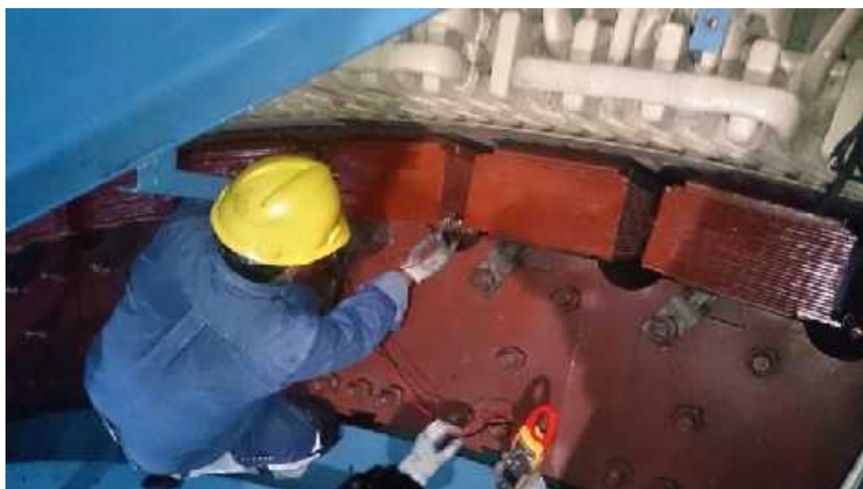
Fig. 4.2.1 Prueba de caída de tensión a los polos del rotor
