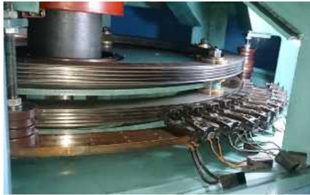
Fig. 2.2.2.4 Anillos rasantes y escobillas
