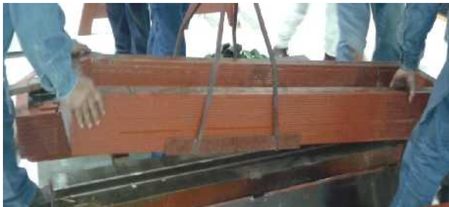
Fig. 2.2.2.2 Núcleo y devanados del polo.
