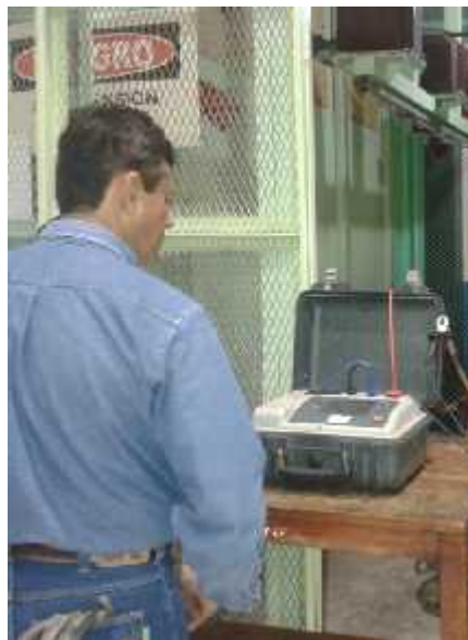
Fig. 4.3.1.1 Prueba de resistencia de aislamiento al transformador de servicios propios
