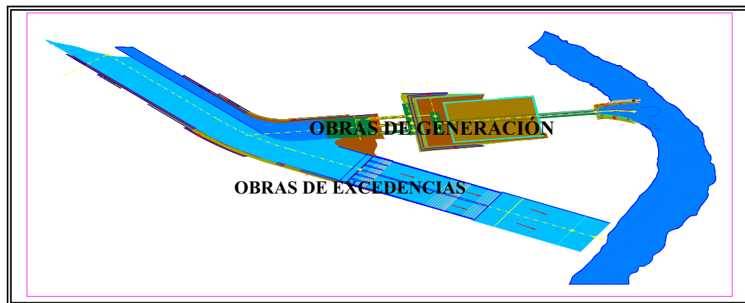
Figura II.3.3.2-67 Estructura que conforman la obra de excedencias se ve en planta la Excavación a cielo abierto de tal obra.
