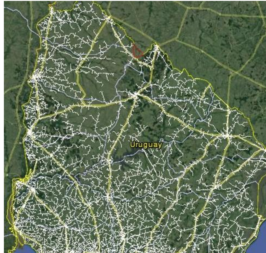
Líneas de media tensión
