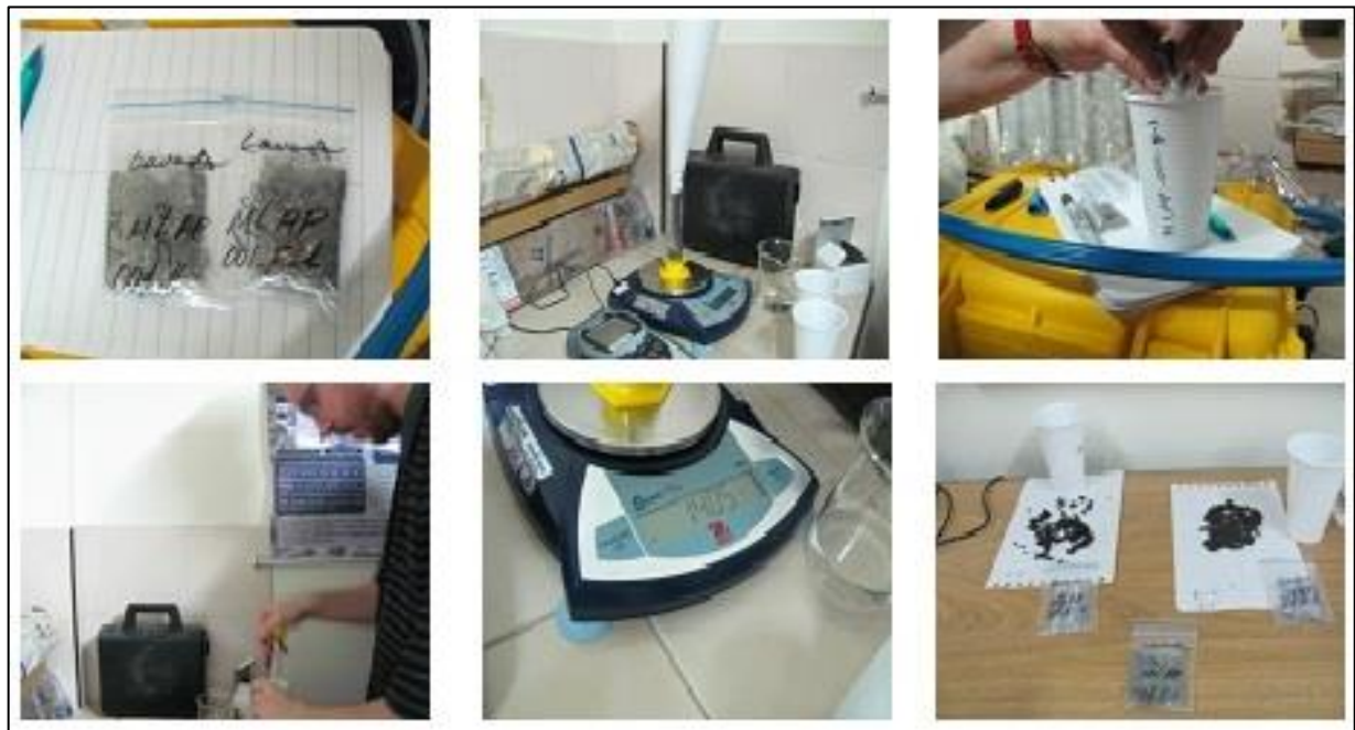
Figura 5. Imágenes del procedimiento en laboratorio para la obtención de la densidad del depósito, que consistió en pesar la muestra, luego sumergirla en agua para hallar el volumen que desplaza y así calcular la densidad.
