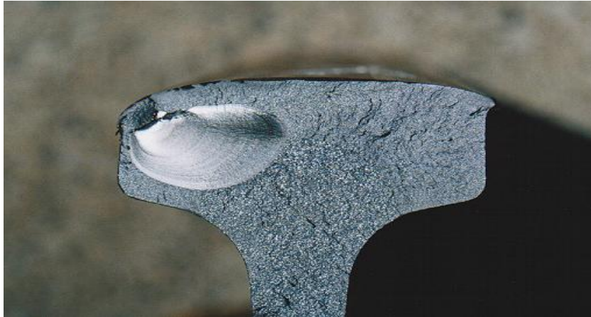
Figur 16. Ett tvärsnitt av rälen som visar Shelling. [24]
